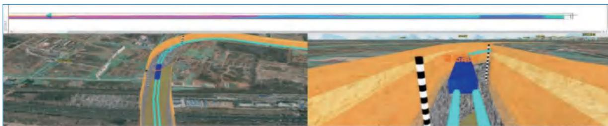
▲ 三维隧道开挖模拟及分析
